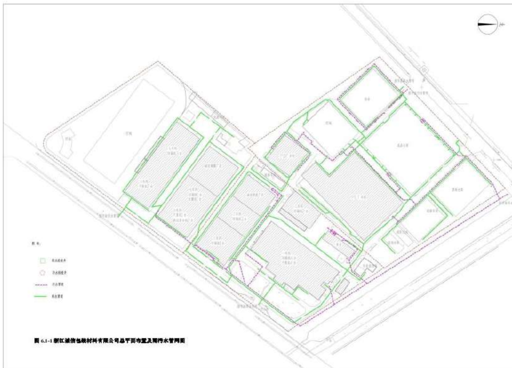
图 2.4.1-2 厂区雨污水管布置图
